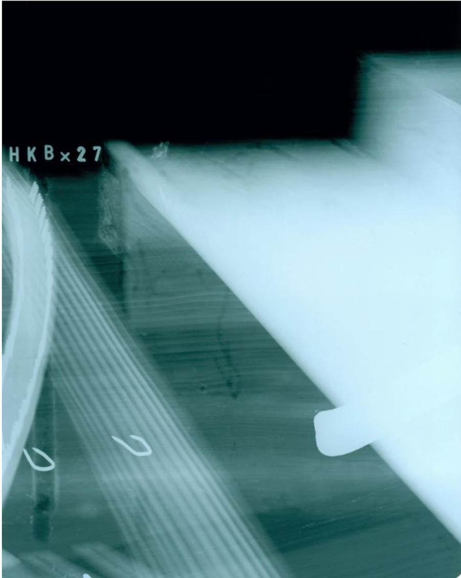
Stimmstock Auflager Diskantseite; keine Zapfen, verdeckte Schrauben oder Schwalbenschwänze
